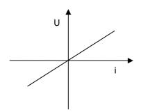
La caractéristique obtenue est un segment de droite qui passe par l'origine. La tension U aux bornes du dipôle est une fonction linéaire de l'intensité qui le traverse et on peut écrire u=ai
