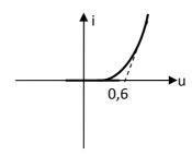
Dans le sens direct la diode conduit à partir de la tension seuil (Us=0,6V). Dans le sens inverse la diode ne conduit pas. C'est un dipôle passif non linéaire non symétrique.
