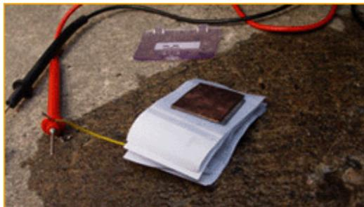
3) Assure-toi que ton multimètre est à la position du voltmètre.
